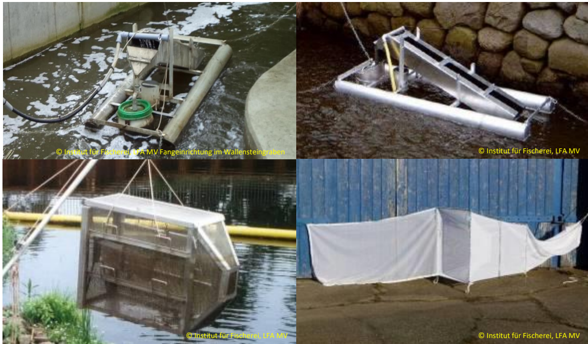
Abbildung 32: Geräte zum Fang junger Aale. Schwimmende Aalrinnen (oben) von der Monitoringstation Wismar. Edelstahlgitterreuse am Fischpass in Dömitz (links unten) und eine mit Gaze bespannte Kastenreuse (unten rechts) in Rostock.
