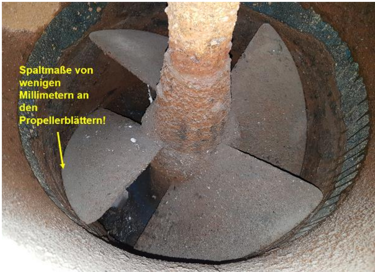
Abbildung 16 Hier ist das Innenleben einer demontierten Turbine vom Wallensteingraben zu sehen. Dort fanden die meisten wassergebundenen Lebewesen den Tod, denn diese Schrauben haben eine hohe Umdrehungszahl! Die Befürworter der Wasserkraft, die Betreiber, die Lobbyisten sowie die politischen und behördlichen Entscheidungsträger sollten diese Bilder immer vor Augen haben, um zu begreifen welche Qualen die Tiere in diesen Anlagen erleiden mussten.
